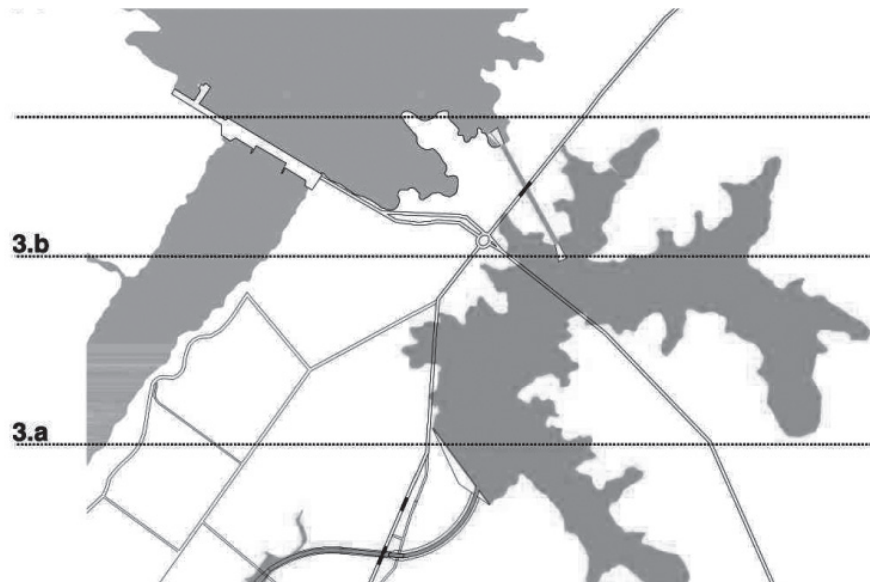
Tramo 3: comprende el Embalse 2 en la cota +36 y el canal de conexión con el lago de Salto Grande
